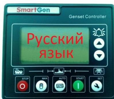
Стандартно на генераторную установку устанавливается контроллер «Smartgen», который представляет собой комплексное устройство с функцией AMF, как для одиночных ДГУ в режиме ожидания, так и для ДГУ в режиме двойного резервирования. Все программируемые параметры, могут быть изменены с передней панели в режиме эксплуатации. В журнал событий включается не только дата, время, информацию, но и полный перечень измеряемых параметров генератора на момент возникновения неисправности.
